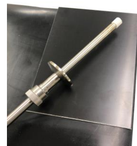
Fig. 1 製作した高温用カーリングプローブの写真
